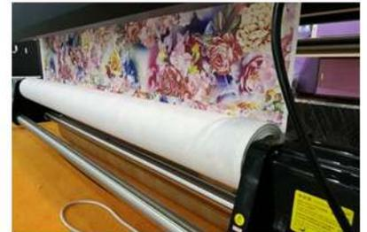
***Sistema estable de alimentación y recogida de material***
