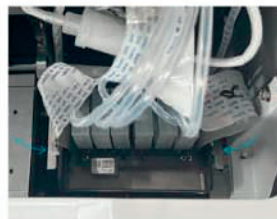
Carro con sensores de seguridad anticolisión en ambos lados.
