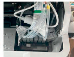
Sistema de circulación de tinta blanca para evitar sedimentos.
