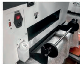
El soporte posterior admite un rollo de 30 cm x 100 m como máximo
