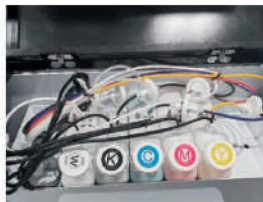
Tanque de tinta recargable con tinta Sensor de falta
